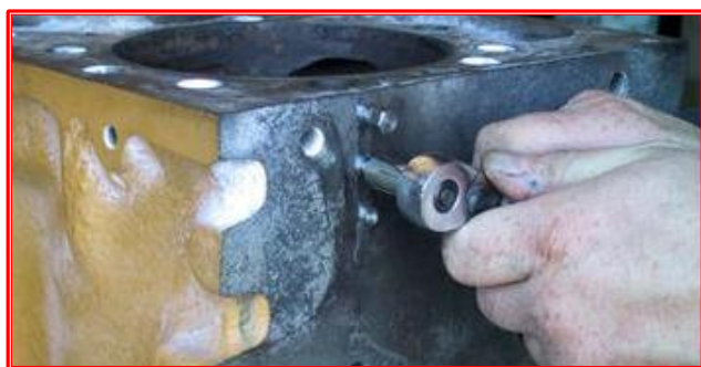
Os pinos de costura finais são instalados criando uma linha contínua de pinos sobrepostos.
