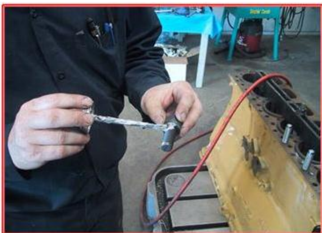
Aplicar anti-aderente na instalação entre a ferramenta e a peça rosçada.
