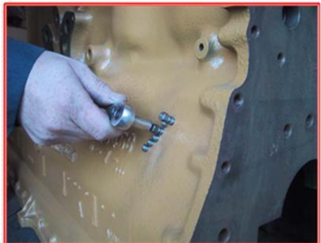
Instalar a primeira série de pinos de costura da série CASTMASTER®.
