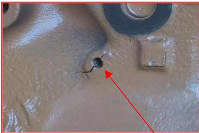
Fissura no orifício do acessório de fixação.
