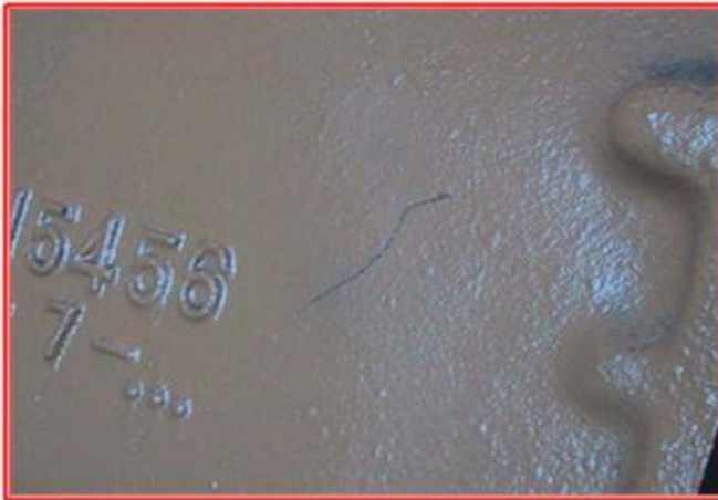
12. Reparação de fissura de 75mm na parede lateral do carter de um bloco.
