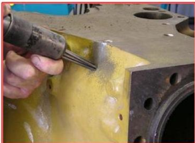
A reparação está completa e texturizada.
