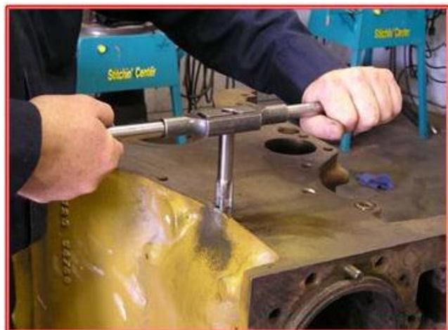
O orifício é roscado com Full-Torque® .
