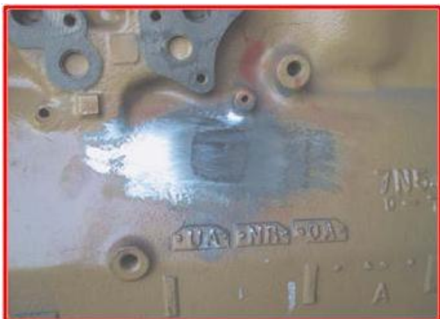
Os pinos de costura e o remendo são lixados e inspeccionados se há fugas. Caso as haja, colocar outro pino.
