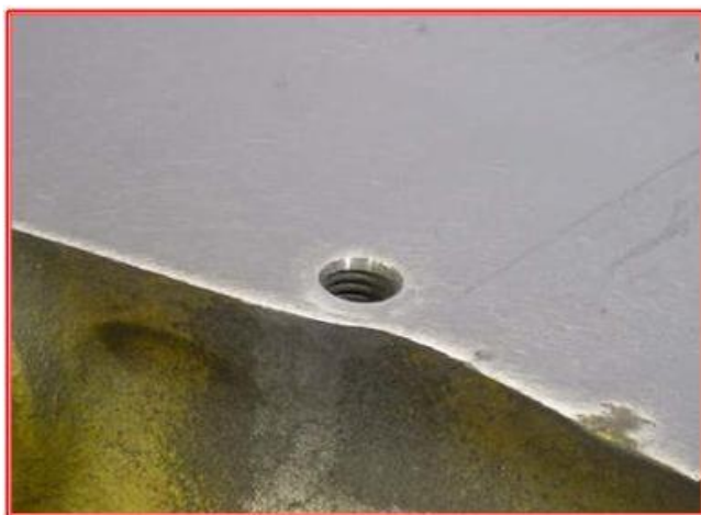
A pressão está completa e a pressão restabelecida. O furo não voltará a rachar.
