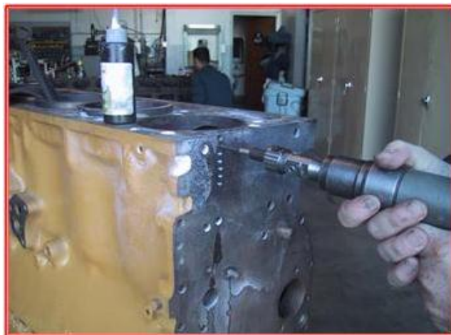
Os furos são roscados com a broca especial CASTMASTER® .
