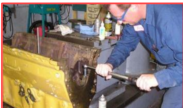
Aparafusar o pino 10% acima do necessário e retirar a porca de instalação.
