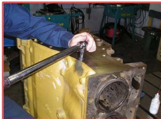
Aparafusar o pino 10% acima do necessário.
