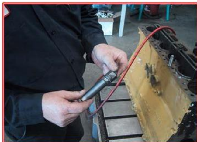
Introduzir Full-Torque® na ferramenta de instalação.
