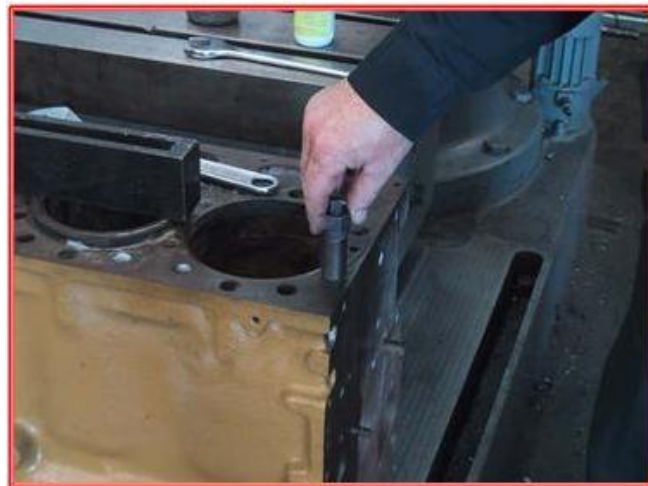
O inserto está aparafusado no furo rosçado.
