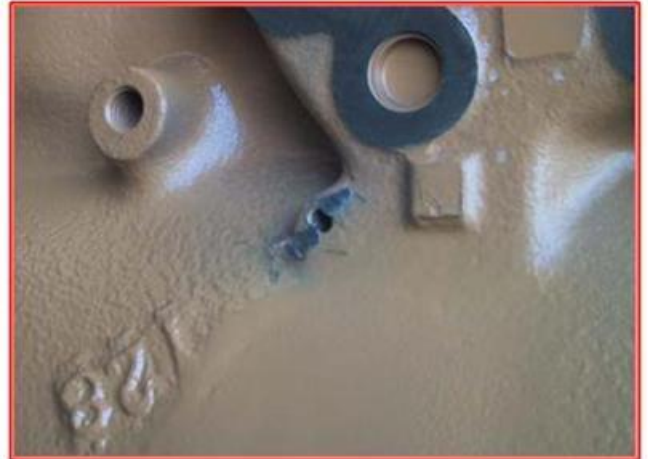
A fissura é cosida com pinos de costura CASTMASTER® .
