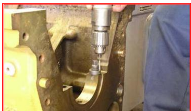
Brocar o pino travão utilizando uma anilha especial para fixar o furo das roscas externas para a inserção.
