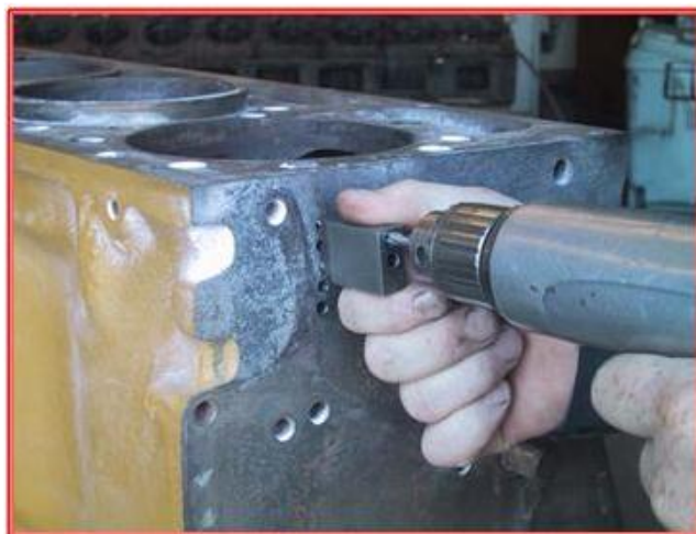
A fissura é primeiro cosida com pinos CASTMASTER® . A primeira série de furos é brocade com ajuda do gabarito.
