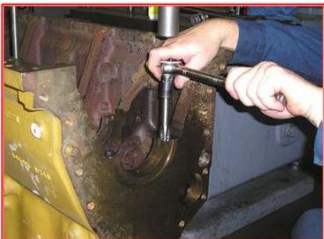
Roscar o novo furo com Full-Torque® .
