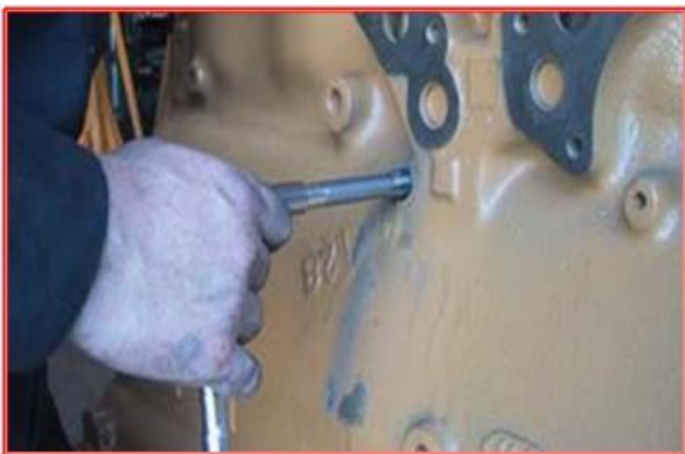
O furo é roscado com a rosca especial Full-Torque® .
