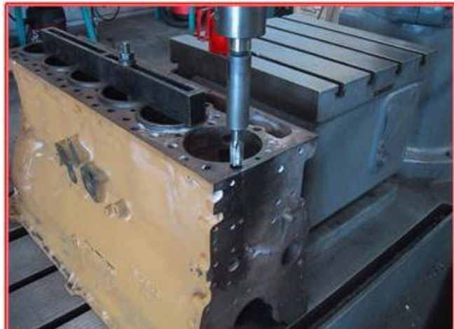
Abrir rosca o furo com a ferramenta especial Full-Torque® .
