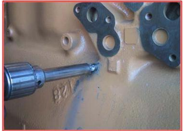
Depois de brocar a rosca danificada cria-se uma reentrancia com uma ferramenta especial para embutir o ombro do pino roscado Full-Torque® .
