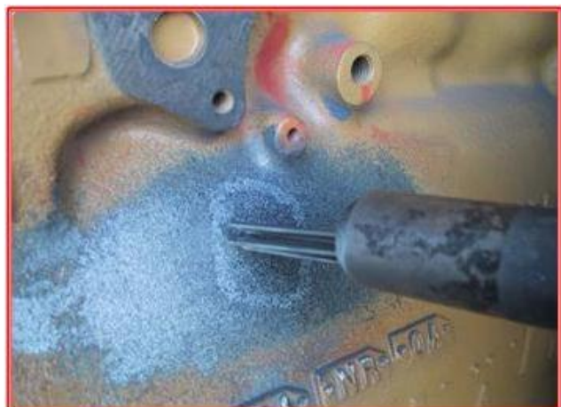
A reparação é texturizada e pronta para a pintura. A reparação é resistente à pressão e estruturalmente forte.
