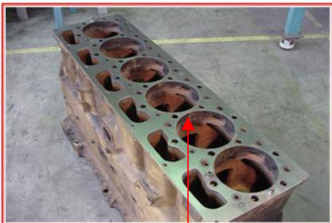
Fissuras entre cilindros
