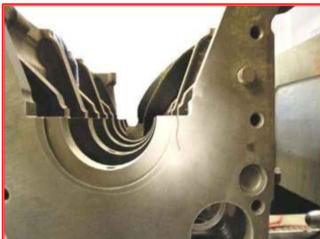
17. Aqui temos uma tampa do bloco de motor com uma racha.
