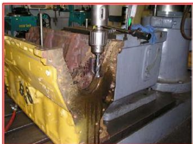
Brocar o furo existente à dimensão do novo insert Full-Torque® .
