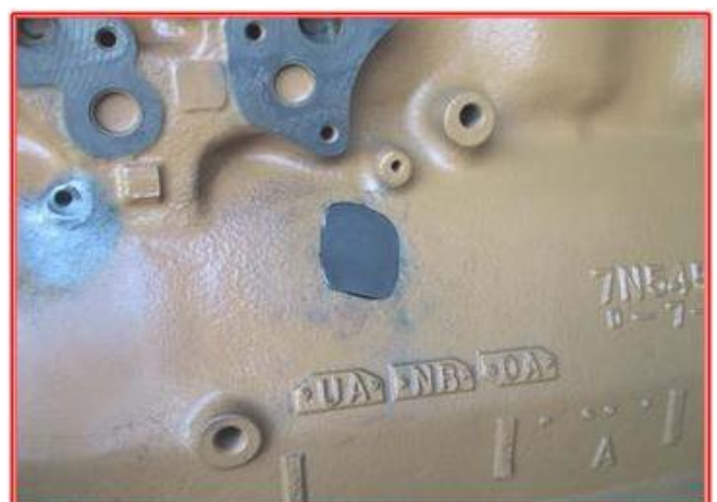
O remendo de aço é colocado no buraco. O aço tem as mesmas propriedades térmicas do ferro fundido e é preferível muitas vezes a remendos de ferro fundido.
