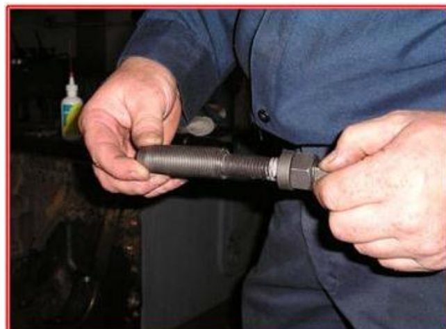
Aparafusar o inserto na ferramenta e inseri-lo no orifício roscado.
