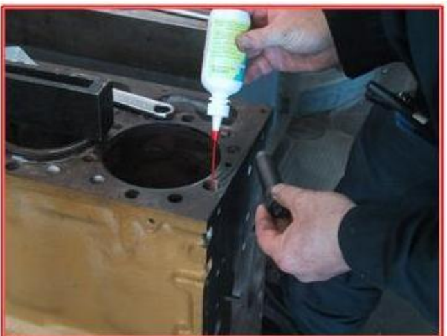
Aplicar o selante/travão ao furo rosçado.
