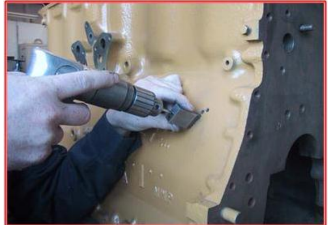
Brocar a primeira série de furos de precisão ao longo da fissura com ajuda do gabarito.
